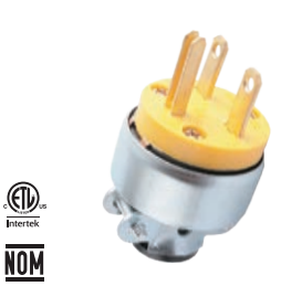
2866 Enchufe blindado con abrazadera metálica | NEMA 6-15, 15A 250V~
