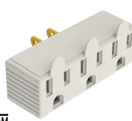
1147 Derivador NEMA 5-15 15A 125V~ 3 salidas
