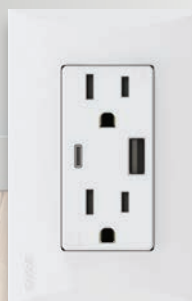
1026 Tomacorriente doble TR con USB / USB-C NEMA 5-15, 15A 125V~ USB-B 2.4A y USB-C 3A
